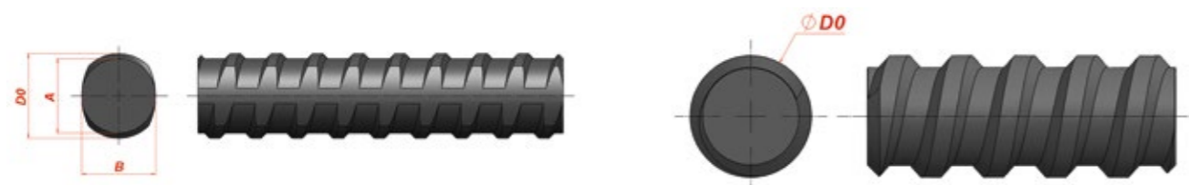
(**) Perfil circular laminado a frio - SAE 1045
