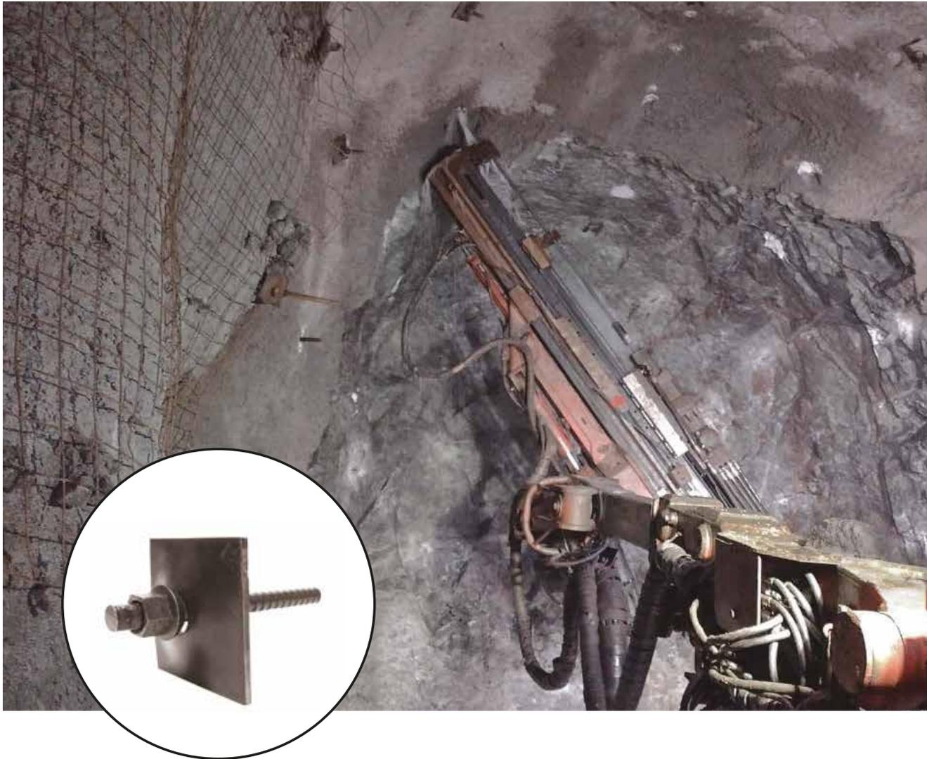
Os Tirantes Threadbolt são produzidos pelo processo de laminação à quente com ressaltos em forma de rosca helicoidal de passo amplo.
